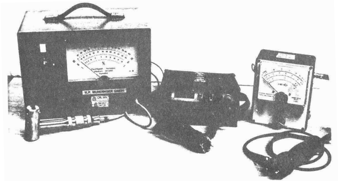
Fig. 1. Medidores de umidade utilizados para determinar os fatores de correção de espécie para sete espécies madeireiras da Amazônia.
